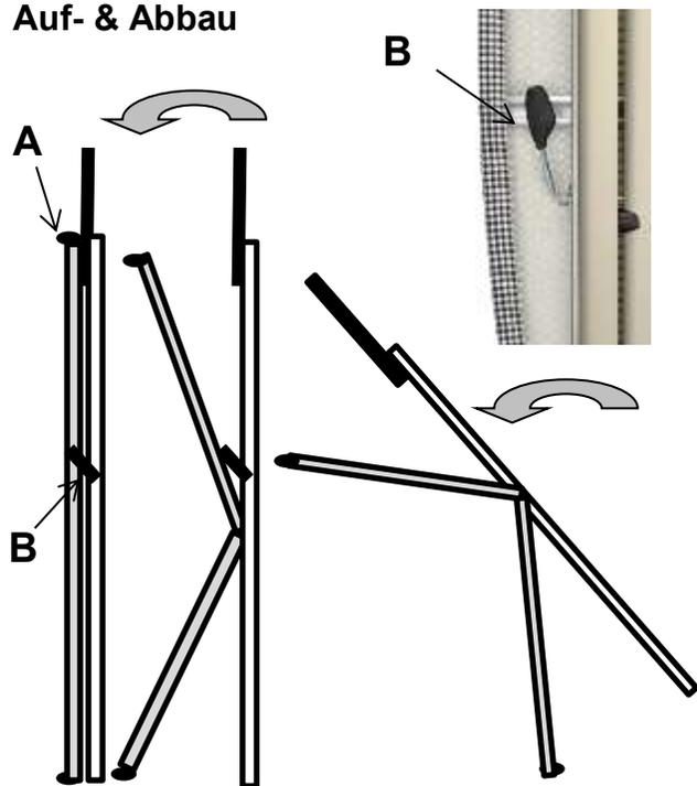
Hebel für Höhenverstellung (B) drücken. Gleichzeitig kurzen Gestellfuß (A) wie eine Schere öffnen und nach unten ziehen. Ist das Gestell komplett ausgefahren, Bügeltisch nach vorne senken bis der Tisch steht.
